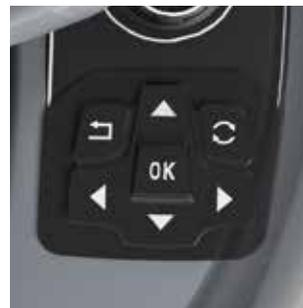
Durante el funcionamiento normal del tractor, la pantalla de información y configuración muestra los datos sobre el régimen del motor, el modo de la transmisión y el tiempo de trabajo. Mediante esta pantalla, también podrá cambiar los distintos valores de ajuste y consultar más información acerca del tractor y su funcionamiento.
