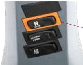
La autotraction se puede activar o desactivar desde el interruptor del pilar b derecho
