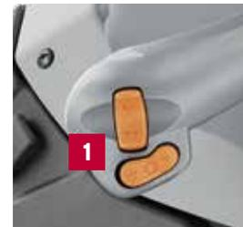
2. Seleccione la dirección de conducción con el inversor, pero mantenga el tractor detenido y con los pedales de embrague y freno pisados.
