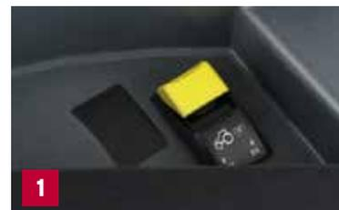
1. La TDF trasera se activa y desactiva a través del interruptor basculante situado en la consola de la derecha.
