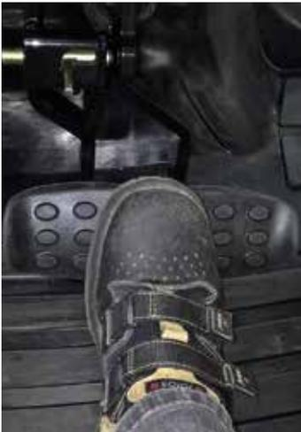
AutoTraction es una opción de serie en los modelos A5 HiTech. AutoTraction minimiza el uso del pedal del embrague para detener el tractor tan solo con los frenos.
