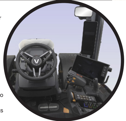
La Serie S está disponible con el sistema de conducción reversible TwinTrac, y potencia Boost que proporciona una gran potencia a la TDF, también en los modelos más grandes.
